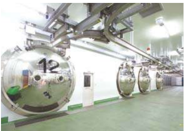
(上)一度に80,000食を乾燥できる、最新鋭の凍結乾燥機 (下)おみそ汁をはじめ、200種類以上のフリーズドライ食品を展開
