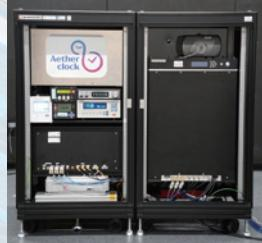
▲開発した小型光格子時計。レーザー冷却された原子を光格子中に捕獲し、低温に冷却した恒温槽の中で時計遷移を高精度に分光する。
